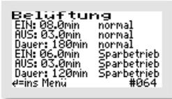
Auch für den Sparbetrieb wird das Belüftungsintervall angezeigt, d. h. für wie viele Minuten die Belüftung „EIN“ bzw. „AUS“ geschaltet wird.
