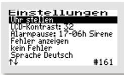
Um die Uhrzeit und/oder das Datum zu korrigieren, wählen Sie mit den -Tasten die Zeile „UHR STELLEN“ aus. Ist die Markierung (=schwarzer Balken) auf dem gewünschten Eintrag, wird mit der mittleren -Taste das Fenster zum Anpassen der Werte geöffnet.
