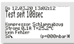
Der Test läuft vollautomatisch ab. Die einzelnen Funktionen werden nacheinander (jeweils ca. 15 Sekunden) geprüft. Funktioniert alles fehlerfrei, kommt keine Alarmmeldung.
