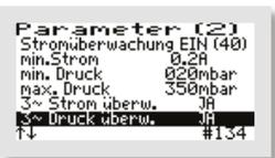
Ist ein Drehstrom-/Drei-Phasen-Verdichter ausgewählt, kann für diesen die Drucküberwachung separat „EIN“ oder „AUS“ geschaltet werden mit dem Menüpunkt „3~DRUCK ÜBERW.“.
