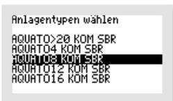
Danach wählen Sie im Fenster „ANLAGENTYPEN WÄHLEN“ die gewünschte bzw. erforderliche EW-Zahl mit den -Tasten aus. Wenn die Markierung (= schwarzer Balken) auf der richtigen EW-Zahl (nach Klärtechnischer Berechnung) steht, bestätigen Sie mit der -Taste. Steht die erforderliche EW-Zahl nicht direkt zur Auswahl, wählen Sie den nächstgrößeren Eintrag.
