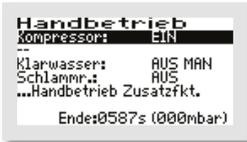
Das Menü Handbetrieb besteht aus 2 Fenstern. Mit den -Tasten kann im ersten Handbetrieb-Fenster (mit den Standardfunktionen) zwischen den stets vorhandenen Parametern „KOMPRESSOR“ und „KLARWASSER“ sowie „SCHLAMMR“ (= Schlammrückführung) ausgewählt werden, indem der schwarze Balken auf den gewünschten Eintrag gesetzt wird.
