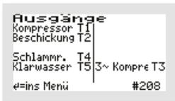
In diesem Beispiel wird der Verdichter über den Ausgang T1 gesteuert, die Beschickung über den Ausgang T2, der Schlammabzug über den Ausgang T4 und der Klarwasserabzug über den Ausgang T5. Dazu wird ein Dreiphasenkompressor über den Ausgang T3 angesteuert.
