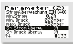
Ist ein Drehstrom-/Drei-Phasen-Verdichter ausgewählt, kann für diesen die Stromüberwachung separat „EIN“ oder „AUS“ geschaltet werden mit dem Menüpunkt „3~STROM ÜBERW.“.
