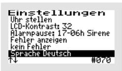
Hier wird die Sprache der Steuerung ausgewählt. Die Eingabe des Passwortes ist dafür nötig. Die Steuerung ist vorbereitet für mehrere Sprachen. Zurzeit programmierte Sprachen sind:
