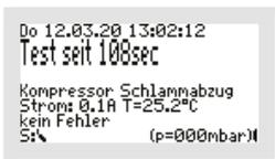
Der Test läuft vollautomatisch ab. Die einzelnen Funktionen werden nacheinander (jeweils ca. 15 Sekunden) geprüft. Funktioniert alles fehlerfrei, kommt keine Alarmmeldung. Der Testbetrieb kann durch Bedienen der
