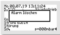
Dadurch wird der Summer abgeschaltet und es öffnet sich das Fenster „ALARM LÖSCHEN“. Direkt danach folgt die Abfrage „SICHER?“
