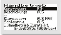
Das Menü Handbetrieb besteht aus 2 Fenstern. Mit den -Tasten kann im ersten Handbetrieb-Fenster (mit den Standardfunktionen) zwischen den stets vorhandenen Parametern „KOMPRESSOR“, „BESCHICKUNG“ und „KLARWASSER“ sowie „SCHLAMMR“ (= Schlammrückführung) ausgewählt werden, indem der schwarze Balken auf den gewünschten Eintrag gesetzt wird. Ist der z. B. der „KOMPRESSOR“ ausgewählt, kann er mit der -Taste „EIN“ und „AUS“ geschaltet werden.
