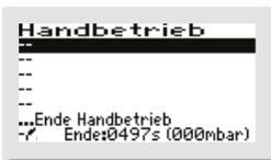
Je nach Voreinstellung können im 2. Handbetrieb-Fenster unterschiedliche Menüpunkte, wie z. B. „2. KOMPRESSOR“ oder „THERMOSTAT“, ausgewählt werden, indem der schwarze Balken auf den gewünschten Eintrag gesetzt wird. Dann wird diese Funktion mit der -Taste „EIN“ und „AUS“ geschaltet.
