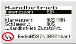
Links unten im Display sind 2 Schwimmerschalter-Symbole mit der aktuellen Schwimmerstellung sichtbar.
