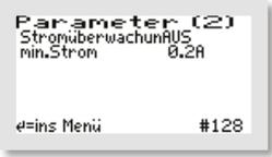
Im Menü „PARAMETER 2“ können, falls erforderlich, der minimale und der maximale erlaubte Druck verändert werden, ebenso der minimale Strom als Überwachungsgrenzwert.
