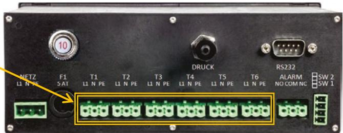
Abbildung 14: Anschluss Klarwasserpumpe
