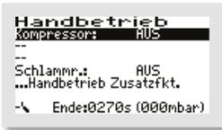
Das Menü Handbetrieb besteht aus 2 Fenstern. Mit den -Tasten kann im ersten Handbetrieb-Fenster (mit den Standardfunktionen) zwischen den stets vorhandenen Parametern „KOMPRESSOR“ und „SCHLAMMR.“ (= Schlammrückführung) (mit den Standardfunktionen) ausgewählt werden, indem der schwarze Balken auf den gewünschten Eintrag gesetzt wird.
