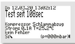
Der Test läuft vollautomatisch ab. Die einzelnen Funktionen werden nacheinander (jeweils ca. 15 Sekunden) geprüft. Funktioniert alles fehlerfrei, kommt keine Alarmmeldung. Der Testbetrieb kann durch Bedienen der
