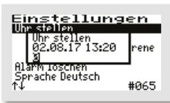
Die erste Ziffer kann mit den -Tasten geändert werden. Ist der richtige Wert eingestellt, wird mit der mittleren -Taste die Ziffer übernommen. Auf die gleiche Art geht es mit allen folgenden Ziffern weiter.
