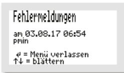
Das Fehlerlogbuch zeigt die letzten 30 Fehlerereignisse mit Datum und Uhrzeit an. Mit den -Tasten wird im Logbuch geblättert, mit der -Taste wird das Menü verlassen.
