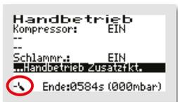
Links unten im Display ist ein Schwimmerschalter-Symbol mit der aktuellen Schwimmerstellung sichtbar.
