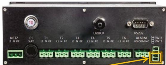
Abbildung 10: Anschluss Schwimmerschalter bei K-Pilot 27.6
