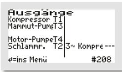
In diesem Beispiel wird der Verdichter über den Ausgang T1 gesteuert und der Schlammabzug über den Ausgang T2. Dazu wird eine Mammut-Pumpe über T3 und eine Motor-Pumpe über T4 angesteuert. Als zusätzliche Funktion wurde bei der Inbetriebnahme ein Dreiphasenkompressor ausgewählt. Diesem muss noch ein Ausgang zugewiesen werden
