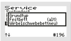
Als erstes wird nach dem „GRUNDTYP“ der Anlage gefragt. Mit den -Tasten wählen Sie den gewünschten Typ in der zweiten Zeile „(NEU)“ aus.
