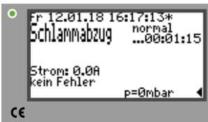
Abbildung 17: Display-Anzeige und LED
