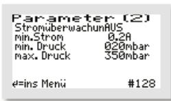
In diesem Menü kann die Stromüberwachung „AUS“ oder „EIN“ geschaltet werden. Im Standardfall ist die Stromüberwachung auf „EIN“ gestellt. (Zusätzlich wird in der Hauptanzeige zur Überwachung der aktuell fließende Strom angezeigt.)
