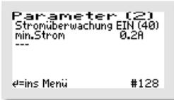
In diesem Menü können, falls erforderlich, der minimale und der maximale erlaubte Druck sowie der min. Strom verändert werden.
