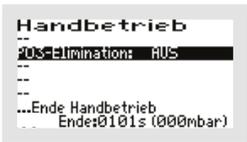
Je nach Voreinstellung können im 2. Handbetrieb-Fenster unterschiedliche Menüpunkte, wie z. B. „2. KOMPRESSOR“, „UV-LAMPE“, oder „PO3-Elimination“ ausgewählt werden, indem der schwarze Balken auf den gewünschten Eintrag gesetzt wird. Dann wird diese Funktion mit der -Taste „EIN“ und „AUS“ geschaltet.
