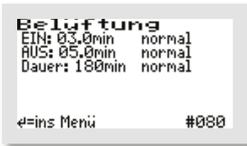
Im Menü „BELÜFTUNG“ werden die ausgewählten Belüftungsintervalle im Normalbetrieb angezeigt, d. h. für wie viele Minuten die Belüftung jeweils im Wechsel „EIN“ bzw. „AUS“ geschaltet wird (Taktung).
