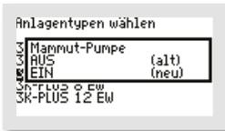
Benötigen Sie zusätzlich zur Standardklärfunktion eine Mammut-Pumpe, wählen Sie im nächsten Fenster „MAMMUT-PUMPE“ in der zweiten Zeile „(NEU)“ mit den -Tasten die Option „EIN“ aus.
