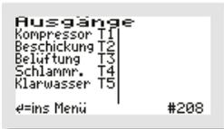
Zusätzlich wird in diesem Beispiel die Belüftung über den Ausgang T3 gesteuert.
