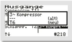
Im Beispiel wird für die Ansteuerung des Dreiphasenkompressors der Ausgang T6 ausgewählt.
