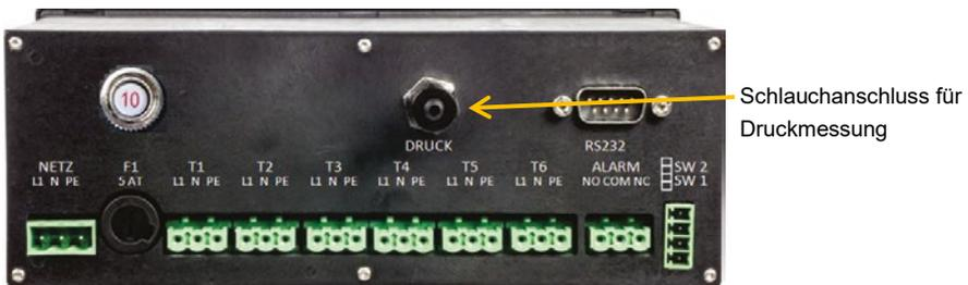
Abbildung 4: Anschluss für Druckmessung an der Steuerung
