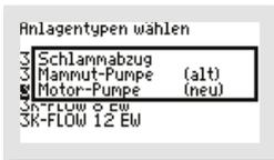
Danach erfolgt die Abfrage, wie der Schlammabzug stattfinden soll, mit einer Tauchmotorpumpe oder mit einem Druckluftheber. Soll die Schlammrückführung mit einer Pumpe statt eines Hebbers durchgeführt werden, wählen Sie im darauf folgenden Fenster „SCHLAMMABZUG“ in der zweiten Zeile „(NEU)“ mit den -Tasten die Option „MOTOR-PUMPE“ aus.
