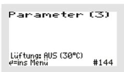
In diesem Beispiel ist ein Lüftungsventilator mit einer Soll-Temperatur von 30 °C angeschlossen. Die Anzeige „AUS“ / „EIN“ hinter dem Wort Lüftung zeigt den aktuellen Betriebszustand des Lüfters an. Im Beispiel ist er ausgeschaltet. Der Lüfter springt bei einer Temperatur von 5 Grad über dem Sollwert (hier: 30 + 5 = 35 °) an und läuft bis 2 Grad (hier: 30 - 2 = 28 °) unter dem Sollwert erreicht sind.
