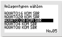
Für die Anlagengrößen von 21 bis 50 EW treffen Sie bitte die Auswahl „AQUATO>20 KOM SBR“. Die Zyklus-Voreinstellungen für die Anlagengrößen von 21 bis 50 EW sind gleich, die unterschiedlichen benötigten Luftmengen werden durch unterschiedliche Größen und Mengen von Membranbelüftern und Verdichtern erreicht. Bei Bedarf können diese Einstellungen nachreguliert werden.
