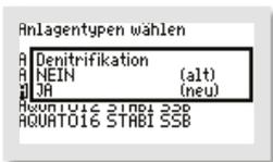
Ist eine „DENITRIFIKATION“ gewünscht/erforderlich, kann diese im nächsten Fenster zugeschaltet werden. In der zweiten Zeile „(NEU)“ kann die gewünschte Option ausgewählt werden. Die Auswahl zwischen „JA“ oder „NEIN“ erfolgt mit den -Tasten. Mit der mittleren -Taste wird der gewählte Zustand übernommen. „JA“ bedeutet, die Anlage läuft mit Denitrifikationsphase, bei „NEIN“ ist diese Phase abgeschaltet.
