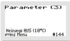
In diesem Beispiel ist eine Heizung mit einer Soll-Temperatur von 10 °C angeschlossen, die z. Zt. ausgeschaltet ist.
