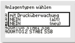
Anschließend folgt im Menü „MIT DRUCKÜBERWACHUNG“ die Entscheidung, ob der 3-Phasen-Verdichter auf Druck überwacht werden soll.
