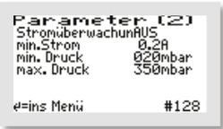
In diesem Menü kann die Stromüberwachung „AUS“ oder „EIN“ geschaltet werden. Im Standardfall ist die Stromüberwachung auf „EIN“ gestellt. (Zusätzlich wird in der Hauptanzeige zur Überwachung der aktuell fließende Strom angezeigt.)
