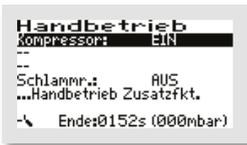
Ist der „KOMPRESSOR“ ausgewählt, kann er mit der -Taste „EIN“ und „AUS“ geschaltet werden.
