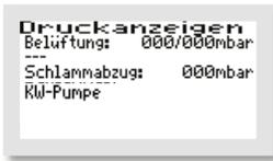
Ist statt des betreffenden Hebers eine Schlamm- und/oder Klarwasserpumpe angeschlossen, wird dies unterhalb der eigentlichen Druckanzeigen als Text angezeigt. Zudem wird dieser Ausgang nicht als Druckausgang angezeigt.
