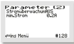
Im Menü „PARAMETER 2“ können auch, falls erforderlich, der minimale und der maximale erlaubte Druck verändert werden, ebenso der minimale Strom als Überwachungsgrenzwert.
