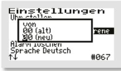
Der akustische Alarm ist standardmäßig von 17.00 Uhr bis 6.00 Uhr abgeschaltet. In dieser Zeit werden Fehler nur optisch angezeigt. Diese Einstellung kann im Menüpunkt „ALARMPAUSE“ geändert werden.
