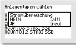
Schalten Sie im Menü „STROMÜBERWACHUNG“ die Überwachung mit der Auswahl von „JA“ ein, gibt es bei Ausfall des Verdichters eine Fehlermeldung.
