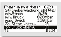
Ist ein Drehstrom-/Drei-Phasen-Verdichter ausgewählt, kann für diesen die Drucküberwachung separat „EIN“ oder „AUS“ geschaltet werden mit dem Menüpunkt „3~DRUCK ÜBERW.“.
