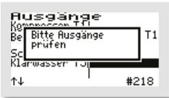
Wird ein Ausgang doppelt ausgewählt, erscheint beim Verlassen des Untermenüs ein Fenster mit der Warnung „Bitte Ausgänge prüfen“ und das Menü wird nicht verlassen, sodass die Auswahl in den betreffenden Zeilen korrigiert werden kann.
