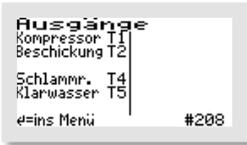
In diesem Beispiel wird der Verdichter über den Ausgang T1 gesteuert, die Beschickung über den Ausgang T2, der Schlammabzug über den Ausgang T4 und der Klarwasserabzug über den Ausgang T5.
