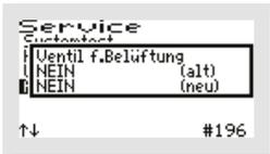
Nach Auswahl des Grundtyps wird im Fenster „VENTIL F. BELÜFTUNG“ abgefragt, ob die Belüftung mit einem Ventil angesteuert wird. Im Standardfall wird die Belüftung ohne Ventil angesteuert. Dazu bestätigen Sie die Auswahl „NEIN“ mit der Taste , um diese Einstellung zu wählen.
