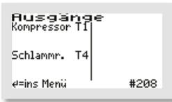
In diesem Beispiel wird der Verdichter über den Ausgang T1 gesteuert und die Schlammrückführung über den Ausgang T4.
