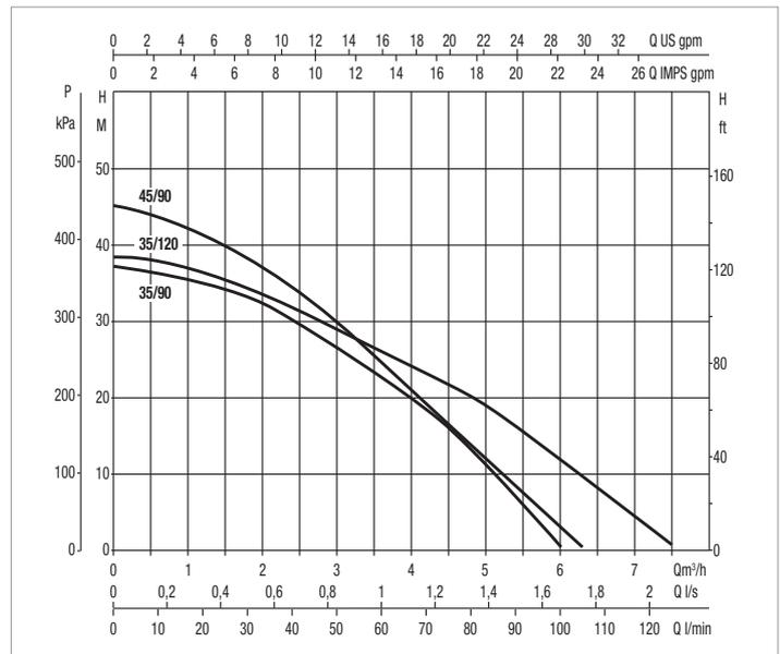
Die Kurven basieren auf eine Viskosität = 1 mm²/s und einer äquivalenten Dichte von 1000kg/m³.
